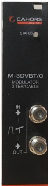
La led d'état sur un modulateur de sortie est verte lorsque le modulateur est prêt avec des chaînes configurées et opérationnelles.
