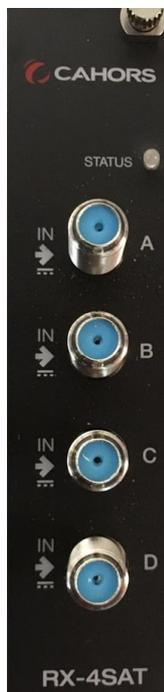
Sur les modules d'entrée : prenons l'exemple d'un module RX-4SAT. Lorsque les 4 tuners sont verrouillés et opérationnels, la led est verte et clignotante 4 fois.
