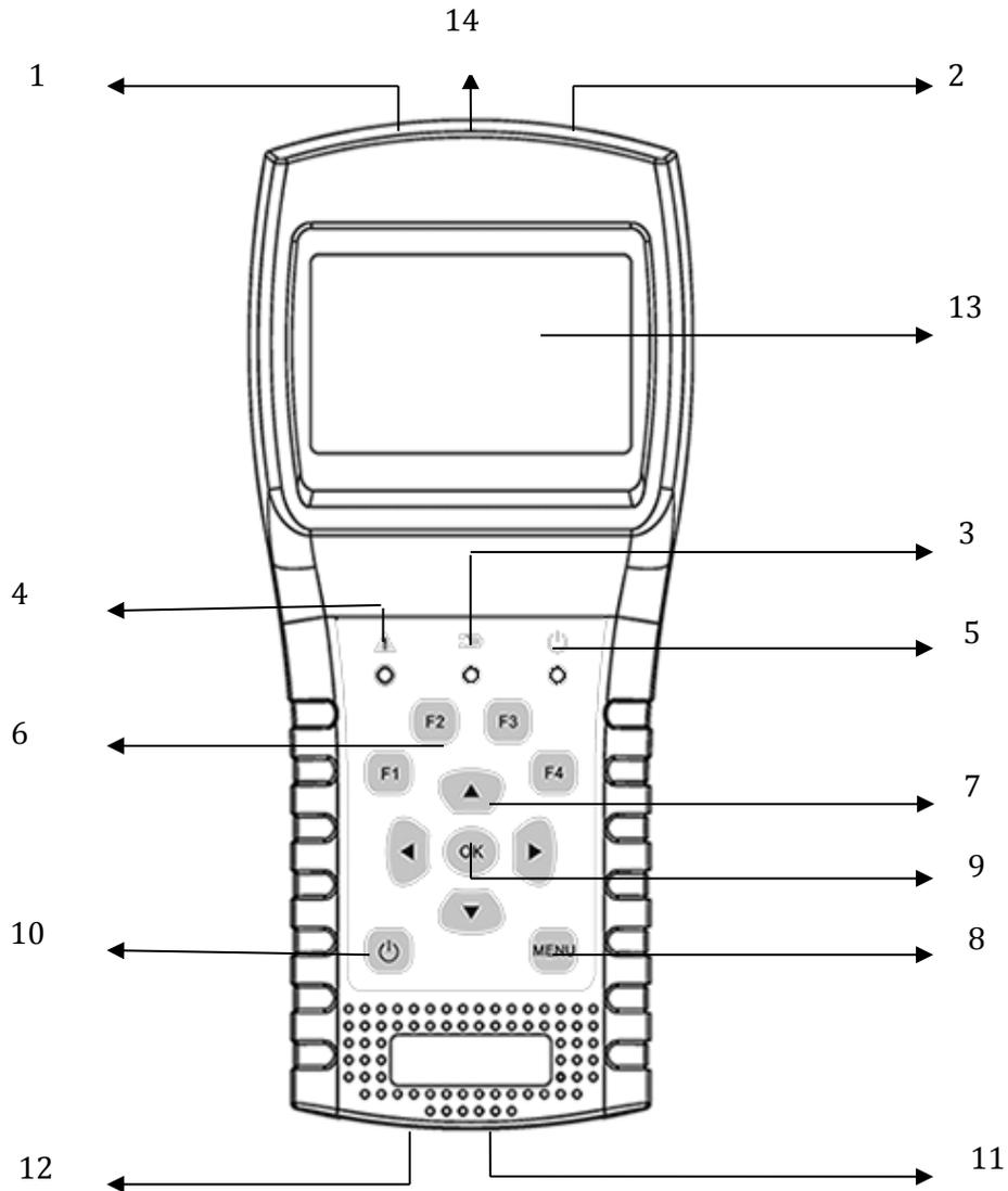
**1. RF In (Antenna Input):** Signal d'entrée pour les normes DVB-T et DVB-C. Connectez directement le câble coaxial sur cette prise.
