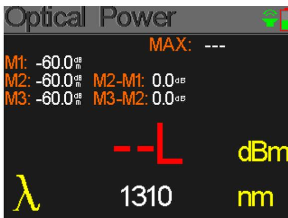
Appuyez sur [▲▼] pour changer la longueur d'onde: 850, 980, 1300, 1310, 1490, 1550 et 1610 nm. Pressez [OK] pour enregistrer la valeur courante mesurée. Appuyez sur [F3] pour basculer du mode mesure de la puissance optique en dBm au mode mesure de l'atténuation en dB et vice-versa.
