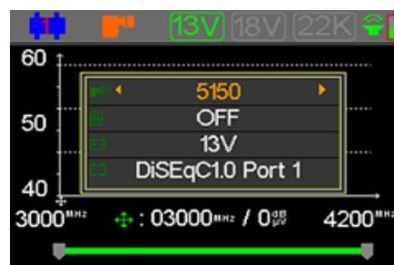
Appuyez sur la touche [OK] pour verifier si la fréquence actuelle peut-être verrouillée ou non. Une boite de dialogue apparaîtra si le transpondeur est verrouillé.
