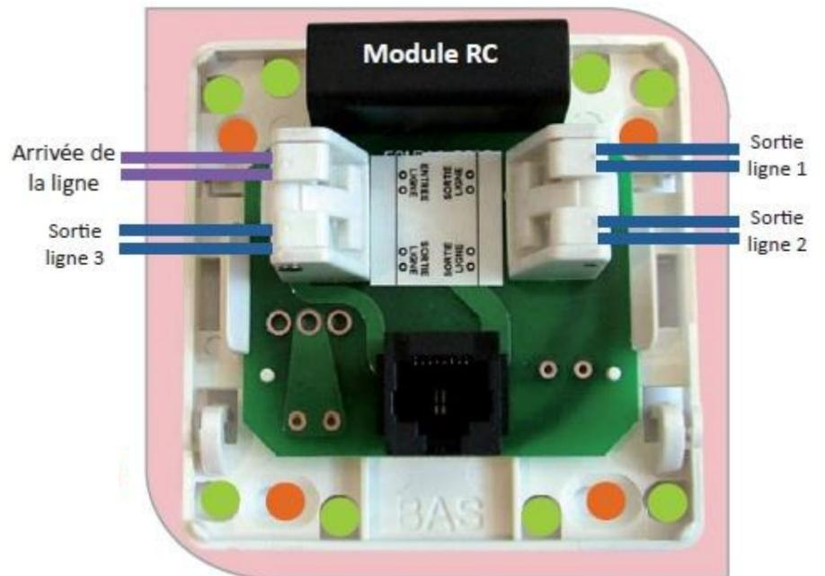
4. Passez le câble à travers le socle. Fixez ensuite ce socle à l'aide de quatre vis Ø max 4 mm ou sur un rail DIN de 35 mm. ●
