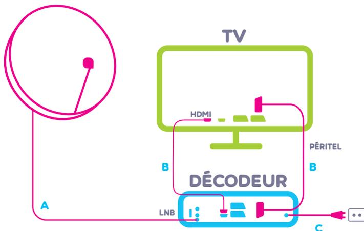
**A** CONNECTEZ LE CÂBLE INTÉRIEUR DE L'ANTENNE SATELLITE À LA PRISE LNB DU DÉCODEUR
