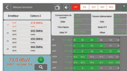
Mesure puissance et qualité du signal Terrestre
