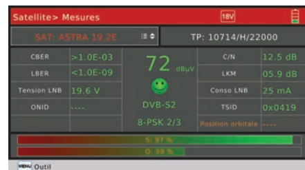
Mesure puissance et qualité du signal Satellite
